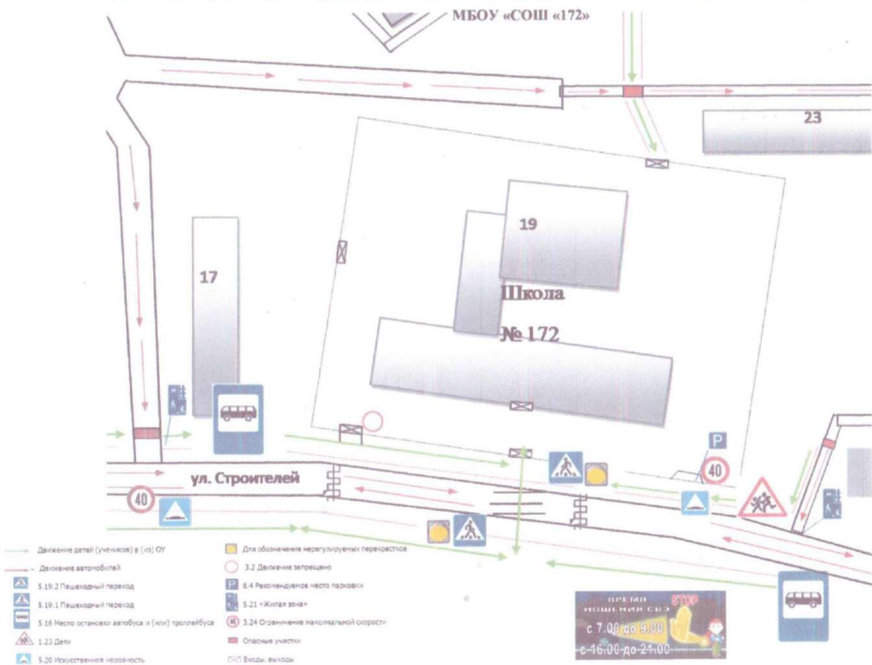
Схема организации дорожного движения в непосредственной близости от образовательной организации с размещением соответствующих технических средств организации дорожного движения, маршруты движения детей и расположение парковочных мест
